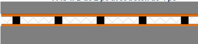
PAC-IFB 2" avec rail, tablier ondulé et béton
